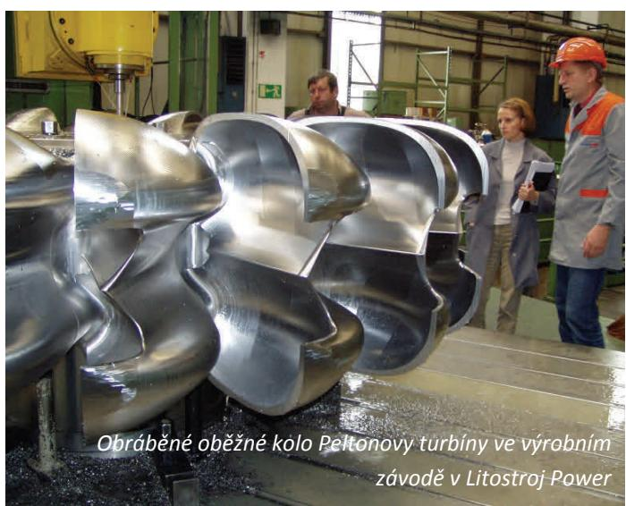
Obráběné oběžné kolo Peltonovy turbíny ve výrobním závodě v Litostroj Power
